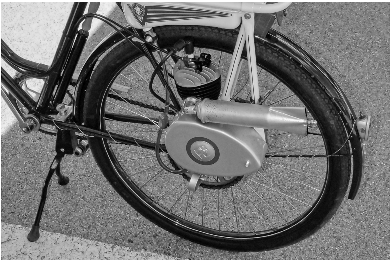
Ein „Fuchs-Motor“ als Hilfsmotor an einem Hinterrad eines Fahrrades. © Peter Krackowizer
