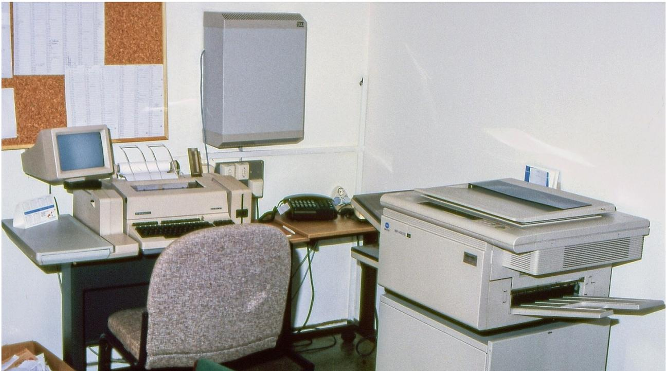
Ein Teil meiner Bürotechnik vor 1990: Links der Telex-Apparat mit Bildschirm mit einem „floppy disk“-Laufwerk für eine Diskette (rechts, der schmale Teil). An der Wand rechts mein Minolta Kopierer mit einer A4- und A3-Papierformat-Lade. Der graue Kasten an der Wand beherbergt die Telefonanlage. An der Pinwand die Urlaubs- und Reiseleiterdaten.
